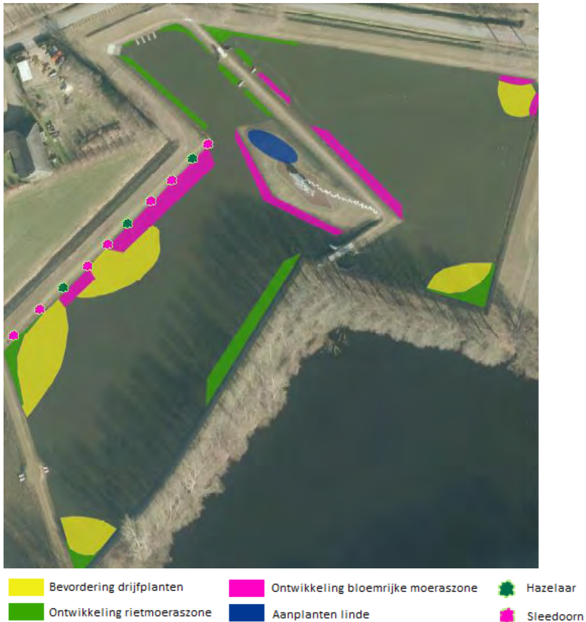
Figuur 6.1 Het eindbeeld van het helofytenfilter tweede fase met de verschillende maatregelen.
